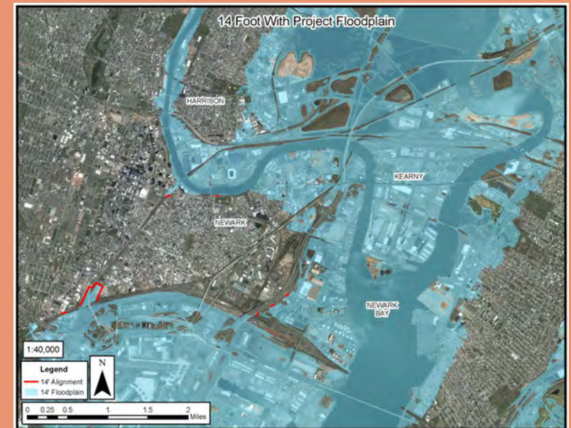
Área de manejo de riesgos del Plan Recomendado con terreno aluvial NAVD88 de 14 pies.
